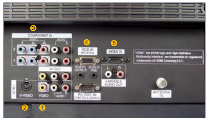
As diversas conexões de vídeo, em ordem crescente de qualidade de imagem: 1 vídeo composto, 2 S-vídeo 3 vídeo componente, 4 VGA (para PCs), 5 HDMI.
